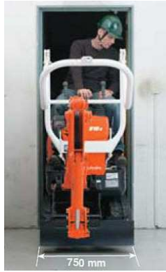
Kurzheckbagger von 10 – 46 PS (Abb. Links U10 (10 PS / 1 to.) / rechts U20 (19 PS / 2,4 to.)
