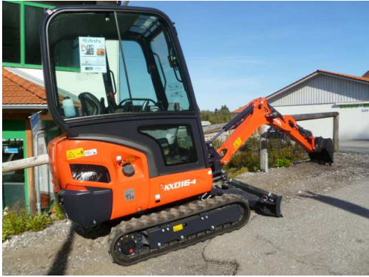
Kompaktbagger von 8 - 65 PS (Abb. Das neueste Modell: KX 016-4 mit 13 PS / 1,5 to.)
