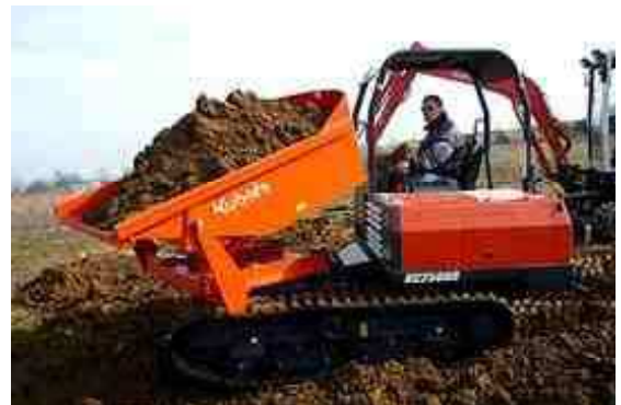
Dumper von Ladekapazität 700 kg (5,5 PS) bis 2500 kg (46 PS)
