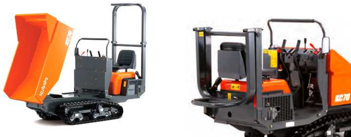
Dumper von Ladekapazität 700 kg (5,5 PS) bis 2500 kg (46 PS)
