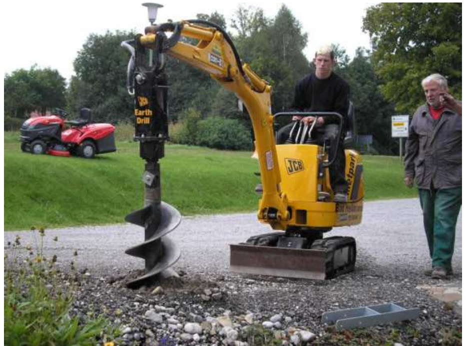
Erdbohrer (Hydraulikmotor) mit Bohrschnecke 30 cm Ø, Länge 1 mtr. (Mietgerät) Listenpreis € 2.460,00 + MwSt. / Sonderpreis € 1.850,00 + MwSt.
