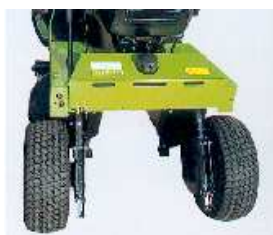
Stelzrahmen, keine störende Hinterachse
