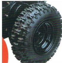
Große Räder und die grobe Stollenbereifung sorgen für eine gute Bodenhaftung. Bei Bedarf können auch Schneeketten montiert werden.
