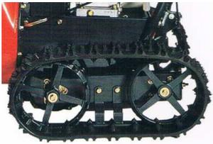
Die Führungsräder der Raupen sind aus robustem Strahlguss gefertigt. Sie garantieren eine spursichere Vorwärtsbewegung auch bei geneigtem Gelände.
